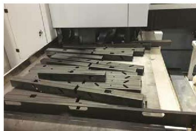
컨베이어와 함께 자동 반출 시스템으로 최대 6m의 관을 제거합니다.
