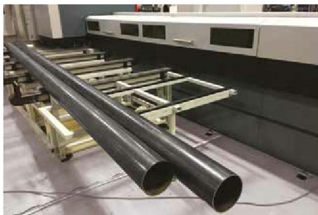
컨베이어와 함께 자동 반출 시스템으로 최대 6m의 관을 제거합니다.
